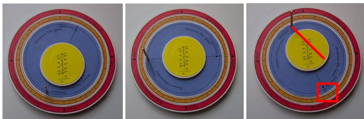
Figuur 6: de homogene analemmatische zonnwijzer; met het instellen van de gnomon verplaatst ook de middenschijf; links en midden: 2 posities van de middenschijf; rechts: een mogelijke schaduw (rond juni); het vierkantje geeft de plaats van tijdaflezing aan.
