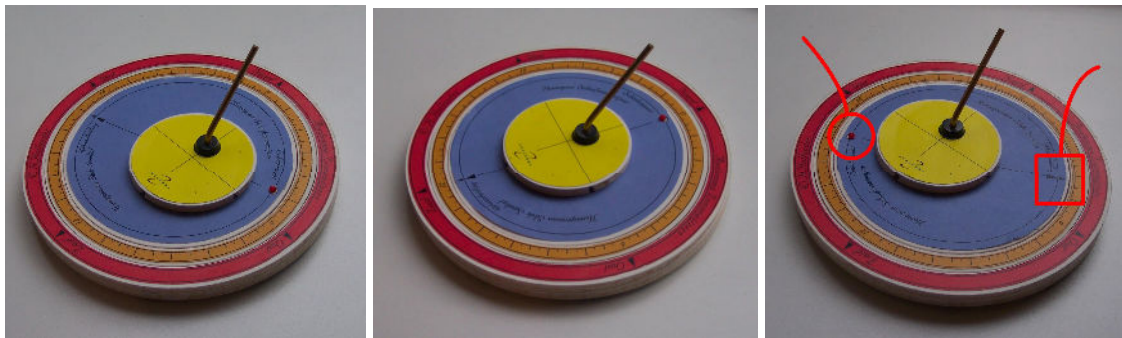
Figuur 8: de homogene analemmatische zonnwijzer met poolstijl; de poolstijl op de middenschijf wijst naar het noorden zoals gebruikelijk; links en midden: 2 posities van de middenschijf; rechts: het rondje geeft de plaats waar de schaduw overheen valt (het schaduwpunt) en het vierkantje geeft de plaats van tijdaflezing.
