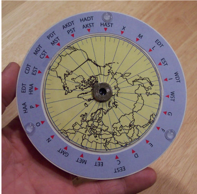
Figuur 10: de achterkant van de zonnwijzer met mogelijkheid tot instellen van de lengtecorrectie met behulp van een wereldkaart en de tijdzones
